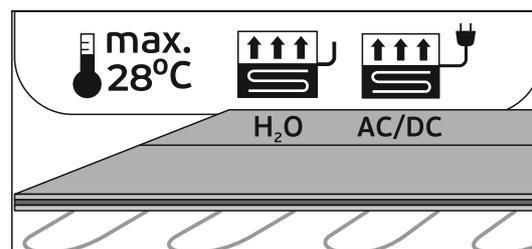
3.2 При укладке SPC-покрытия высокой плотности (кварцевого паркета) на подогреваемые полы систему нужно отключить за 3-4 суток до начала укладки и включить после завершения всех работ по монтажу напольного покрытия.
