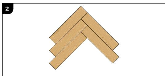
Тщательно проверьте стыки между плашками на отсутствие зазоров после добавления каждой следующей.
