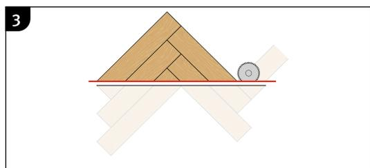
Распилите треугольник по указанной красной линии. В зависимости от типа пилы, которую вы используете, может быть целесообразным разобрать треугольник перед распиливанием.
