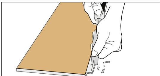
Демонтируйте замок, как показано на рисунке. Для соединения плашек используйте клей.
