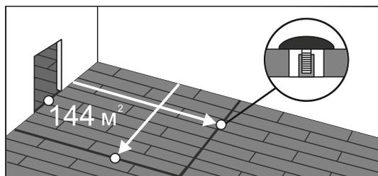
7.10 Площадь максимально возможной беспороговой укладки до 144 м<sup>2</sup> при условии, что максимальная длина и ширина непрерывного ряда должна составлять не более 12 м. При отсутствии разрывов в укладке кварцевого паркета в дверных проемах общая длина или ширина – это сумма длин или ширин всех комнат.
