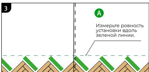
Установите А-образные плашки, как показано на рисунке. Тщательно проверьте стык между плашкой А и треугольником. Не должно быть никаких выступающих краёв и зазоров!
